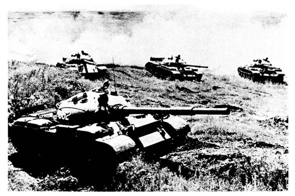
**T 62** - dati tecnici: peso per il cbt: 37,5 t - Armamento: 1 can corazzato 115 mm con canna liscia (45 colpi); 1 mitr 7,62 mm (2200 colpi) - Motore/Potenza: Diesel 580 PS; rapp potenza/peso: 15,5 PS/t; velocità max.: 54 km/h; autonomia: 300/550 km — Equipaggio: 4 uomini.
