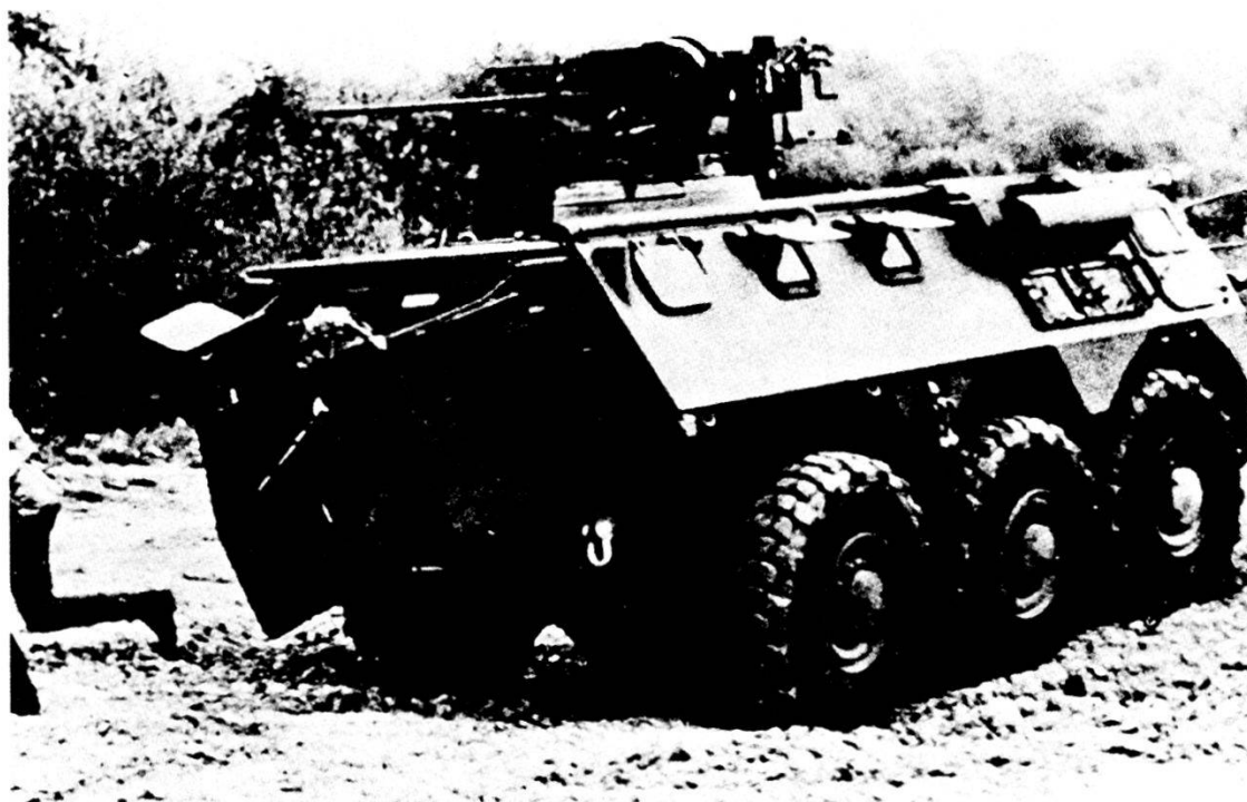
VAB (Francia) — Il VAB (Véhicule de l'avant blindé) è un veicolo corazzato a scopi multipli; è disponibile con 4 o 6 ruote. È anfibo ed ha la possibilità di superare pendii molto ripidi. Dispone di un motore da 260 PS con cambio automatico.
