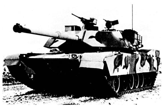
Dati tecnici: peso: 54,4 t (pronto al cbt) - Armamento: 1 can 120 mm (50 colpi) a canna liscia; 3 mitr 7,62 - Motore/potenza: turbina a gas 1500 PS; rapp potenza/peso: 27,6 PS/t; velocità max: 70 km/h; autonomia: circa 500 km - Equipaggio: 4 uomini.
