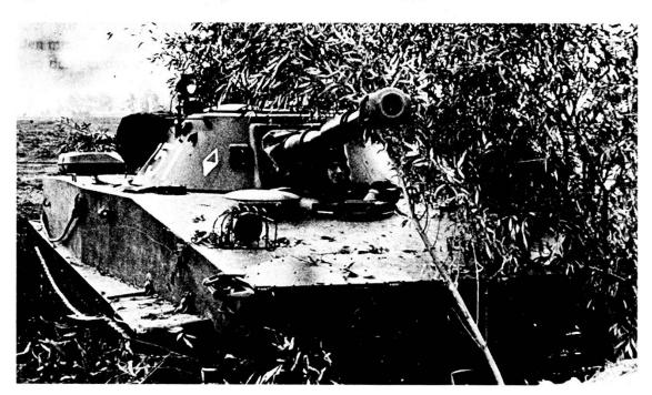
PT 76 — dati tecnici: peso per il cbt: 14,6 t - Armamento: 1 can 76,2 mm (40 colpi); 1 mitr di 7,62 mm parallela alla canna del can (1008 colpi) - Motore/potenza: Diesel 240 PS; rapp potenza/peso: 17,4 PS/t; velocità max: 45 km/h su strada, 10 km/h in acqua; autonomia: 250 km - Equipaggio: 3 uomini.
