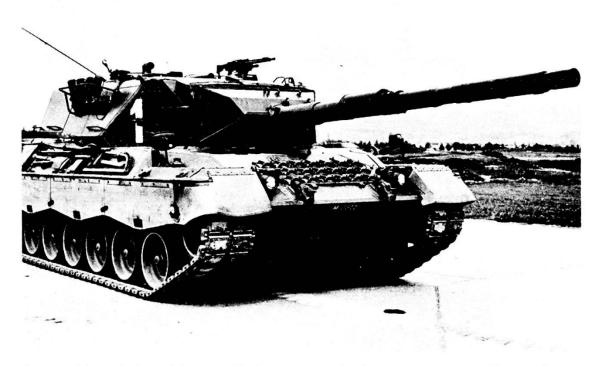
**Leopard 1** — *dati tecnici:* peso: 40 t (pronto al cbt) - Armamento: 1 can 105 mm (60 colpi); 1 mitr 7,62 mm; 1 mitr DCA 7,62 mm - Motore/potenza: Diesel pluricarb 820 PS; rapp potenza/peso: 20,8 PS/t; velocità max: 65 km/h; autonomia: 600 km - Equipaggio: 4 uomini.
