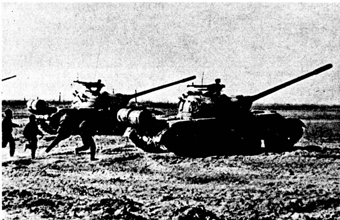
T 54 — dati tecnici : Peso per il cbt 35 t - Armamento: 1 can a pluriuso 100 mm, 34 colpi; 1 mitr 12,7 mm (colpi 500); 2 mitr 7,62 mm (3000 colpi) - Motore/potenza: Diesel 570 PS; rapp pot/peso 16,3 PS/t; velocità max: 50 km/h; autonomia: 350/500 km (senza, risp. con serbatoi supplementari) - Equipaggio: 4 uomini.
