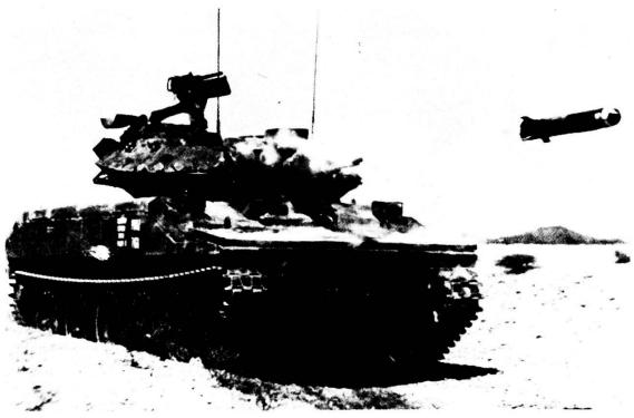
Dati tecnici: peso 15,3 t - Armamento: 1 can 152 mm per «Shillelagh» (10 colpi) e per «Heat» (20 colpi); 1 mitr 7,62 coassiale; 1 mitr DCA 12,7 mm - Motore/potenza: Diesel 300 PS; rapp potenza/peso: 20 PS/t; velocità max: su terreno 70 km/h, in acqua 5 km/h; autonomia: 700 km - Equipaggio: 4 uomini.
