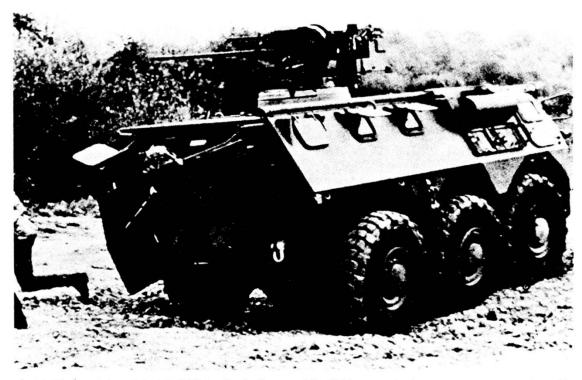
VAB (Francia) — Il VAB (Véhicule de l'avant blindé) è un veicolo corazzato a scopi multipli; è disponibile con 4 o 6 ruote. È anfibio ed ha la possibilità di superare pendii molto ripidi. Dispone di un motore da 260 PS con cambio automatico.
