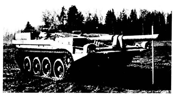
**S 103 B (Svezia)** — Concezione interessante per un carro senza torretta. Ottima sagoma. Allineamento per il tiro tramite manovra del carro e sistema idropneumatico di sospensione in linea verticale.
