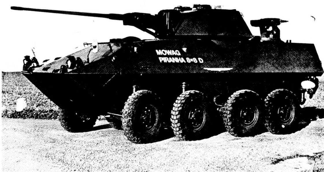
Piranha Mowag (Svizzera) — Veicolo a ruote ( 4 \times 4 , 6 \times 6 oppure 8 \times 8 ) di concezione moderna; anfibio. È adatto al montaggio di 1 can di 90 mm o di altre armi. Veicolo veloce sia sul terreno che in acqua (100 km/h, rispettivamente 10 km/h).
