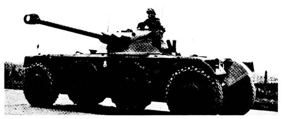
Dati tecnici: peso: 13 t (pronto al cbt) - Armamento: 1 can 9 cm; 3 mitr 7,5 mm - Moto-re/potenza: Otto 200 PS; velocità max: 105 km/h; autonomia: 600 km — Equipaggio: 4 uomini.
