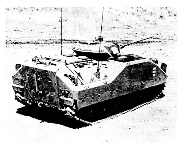
Dati tecnici: peso: 19,5 t (pronto al cbt) — Armamento: 1 can 25 mm (600 colpi); 1 mitr 7,62 mm - Motore/potenza: Diesel 280 PS; rapp potenza/peso: 23,1 PS/t; velocità max: su terreno 72 km/h, in acqua 8 km/h; autonomia: 480 km - Equipaggio: 3+8 uomini.
