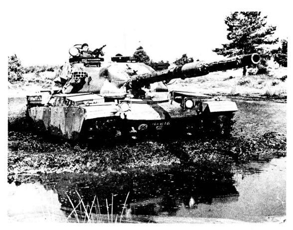
Dati tecnici: peso: 52,2 t (pronto al cbt) - Armamento: 1 can 120 mm (53 colpi); 1 mitr d'aggiustamento 12,7 mm; 1 mitr parallela alla canna 7,52 mm; 1 mitr DCA 7,62 - Motore/potenza: motore pluricarb 710 PS; rapp potenza/peso: 15,5 PS/t; velocità max: 44 km/h; autonomia: 500 km — Equipaggio: 4 uomini.
