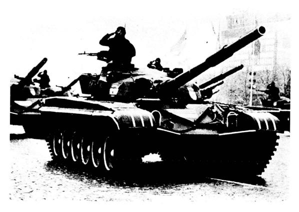
T 72 — dati tecnici: peso per il cbt: 36 t - Armamento: 1 can corazzato 125 mm a canna liscia (40 colpi); 1 mitr 12,7 mm; 1 mitr 7,62 - Motore/Potenza: Diesel 800 PS; rapp potenza/peso: 22,2 PS/t; velocità max: 70 km/h; autonomia: 500 km - Equipaggio: 3 uomini.
