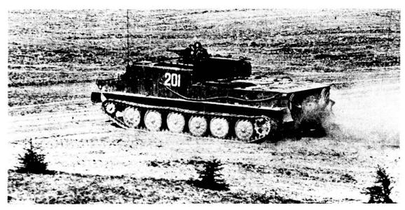
BTR 50 - dati tecnici: peso per il cbt: 13,6 t - Armamento: 1 can corazzato automatico, 73 mm (40 colpi); starter per razzi PAL «Sagger»; 1 mitr 7,62 mm - Motore/potenza: Diesel 280 PS; rapp potenza/peso: 22,2 PS/t; velocità max: su strada 55 km/h; in acqua 8 km; autonomia: 320 km - Equipaggio: 3 + 8 uomini.
