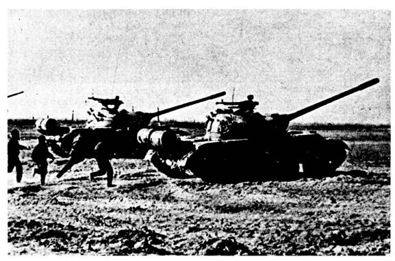
**T 54** — *dati tecnici:* Peso per il cbt 35 t - Armamento: 1 can a pluriuso 100 mm, 34 colpi; 1 mitr 12,7 mm (colpi 500); 2 mitr 7,62 mm (3000 colpi) - Motore/potenza: Diesel 570 PS; rapp pot/peso 16,3 PS/t; velocità max: 50 km/h; autonomia: 350/500 km (senza, risp. con serbatoi supplementari) - Equipaggio: 4 uomini.
