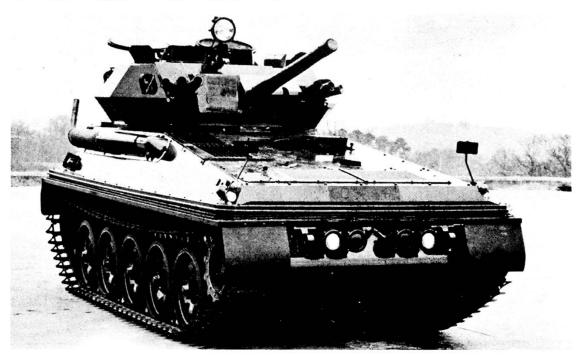
Scorpion (Inghilterra) — Corazza in alluminio di recente concezione; è anfibio e paracadutabile. Buon rapp potenza/peso: 26 PS/t. Dispone di 1 can 76 mm e di 1 mitr 7,62 mm. È dotato di congegni passivi di mira e di marcia notturna.
