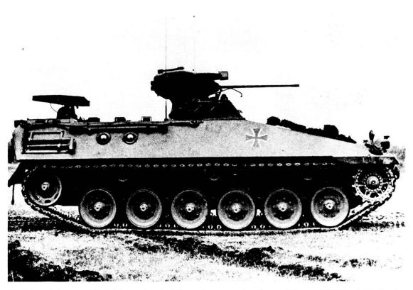
Dati tecnici: peso: 28,2 t (pronto al cbt) — Armamento: 1 can 20 mm (2500 colpi); 2 mitr 7,62 mm (1 mitr su affusto posteriore) — Motore/potenza: Diesel 600 PS; rapp potenza/peso: 21,3 PS/t; velocità max: 75 km/h; autonomia: 520 km - Equipaggio: 3 + 8 uomini.
