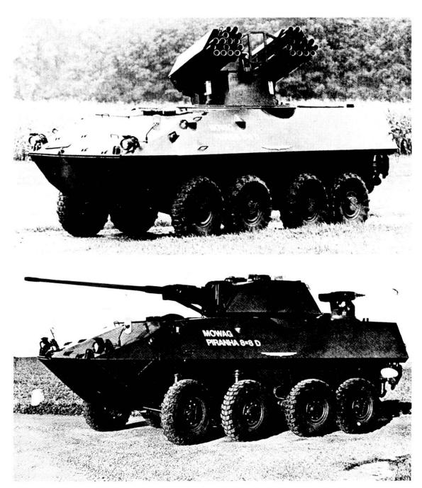
**Piranha Mowag (Svizzera)** — Veicolo a ruote  $(4 \times 4, 6 \times 6)$  oppure  $8 \times 8$  di concezione moderna; anfibio. È adatto al montaggio di 1 can di 90 mm o di altre armi. Veicolo veloce sia sul terreno che in acqua (100 km/h), rispettivamente 10 km/h).
