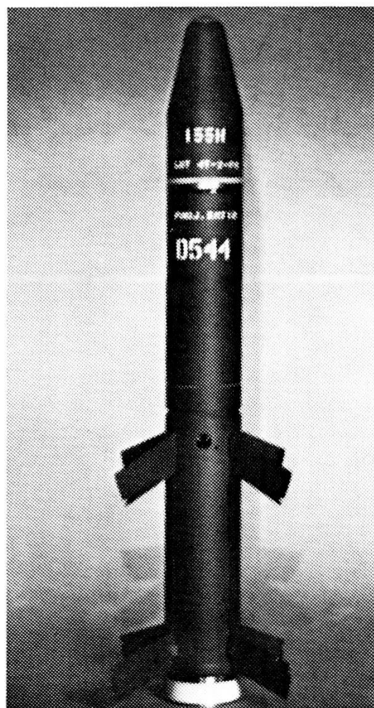
Illustrazione 4: Un «Cannon Launched Guided Projectile» - un proiettile d'art con «senso dell'obiettivo».
