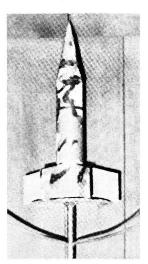
Illustrazione 4: Sensore che lavora con movimento sismico, lanciato da un aereo o da un elicottero. Si badi all'ala di stabilizzazione e all'antenna sporgente, a forma di asta.
