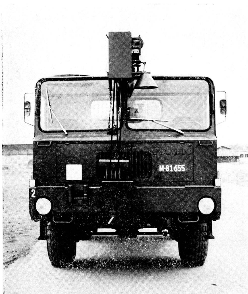
Fronte del camion grue con il braccio adagiato pronto per lo spostamento.
