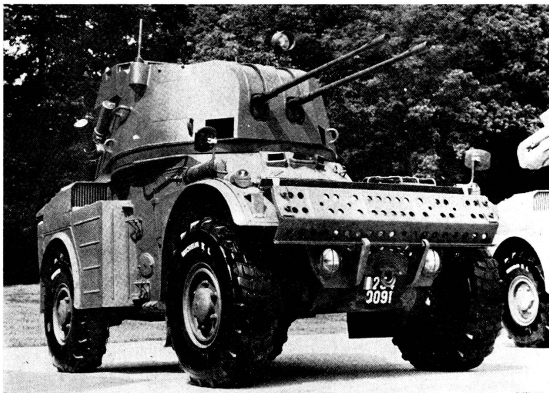
L'AML S 530 ultima realizzazione della Panhard. Veicolo corazzato leggero con torretta girevole dotata di due can DCA 20 mm
