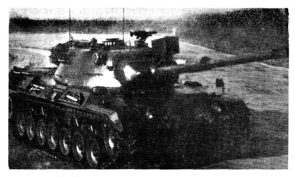
Il "Leopard" visto di fronte con in evidenza la bocca da fuoco e il proiettore IR.
