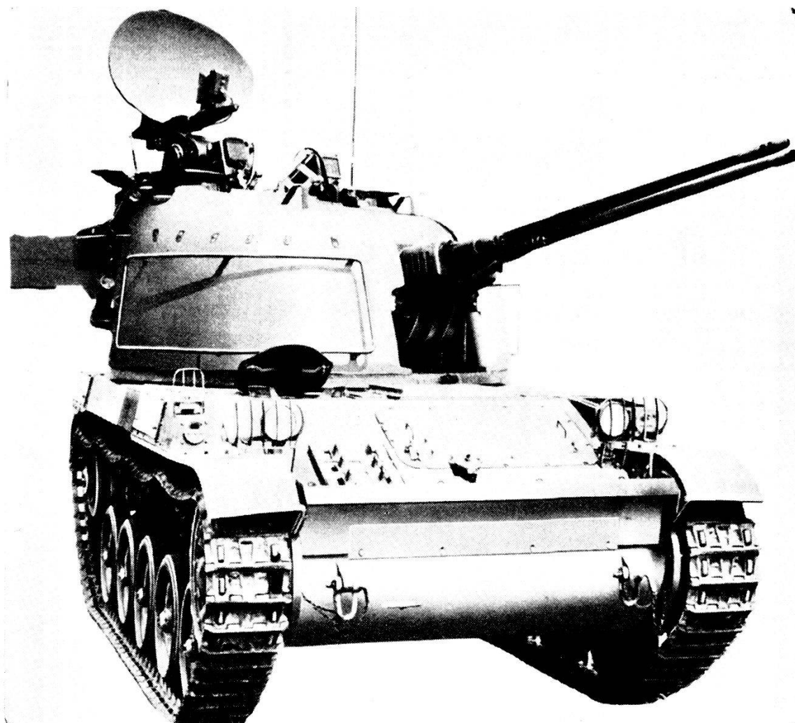
Cannone antiaereo calibro 30 mm, a due canne su scafo AMX 13 dotato di radar direttore di tiro, Occhio nero.
