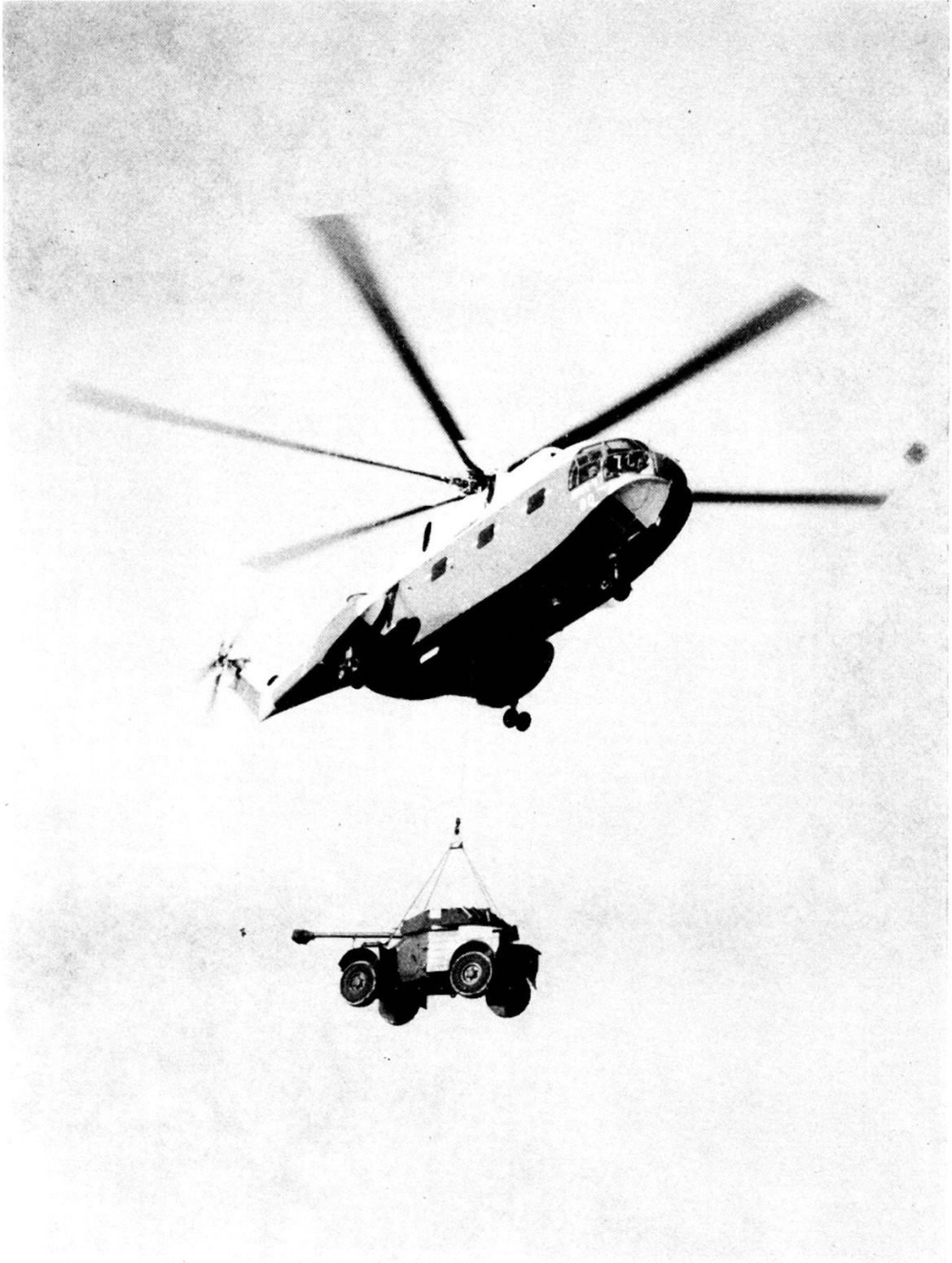
Elicottero Super-Frelon in dotazione all'esercito francese. Trasporta un veicolo corazzato di esplorazione AML 245 (RMSI I 64)
