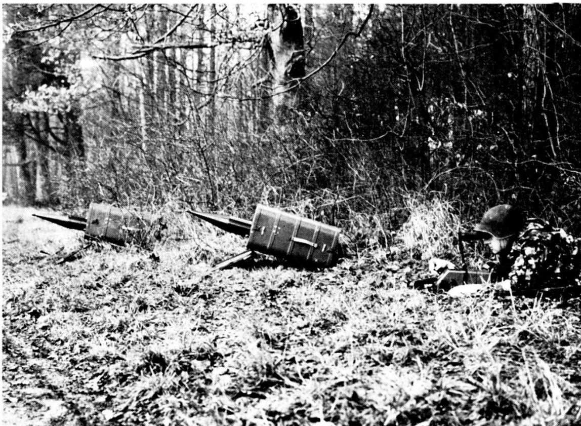
Mosquito 64 - Apparecchio di guida con missili pronti per l'impiego
