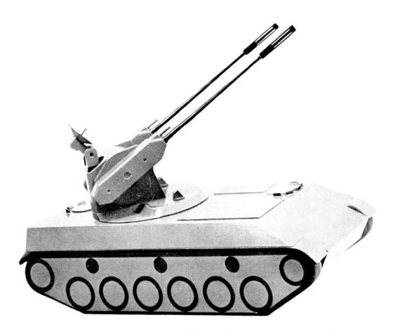
Modello di un cannone antiaereo OERLIKON a due canne calibro 35 mm. Congegno di tiro elettronico.
