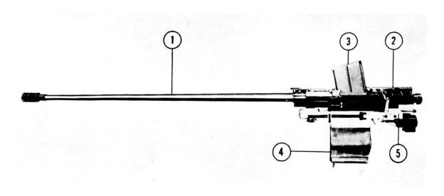
Il cannone Oerlikon cal. 20 mm del carro Pz 61 1 canna con freno di bocca; 2. arma; 3. magazzino; 4. sacco bossoli; 5. culla.
