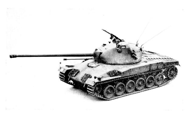
Carro Pz. 61; Classe 35 t.; Armamento: cannone ac. 10,5 cm; cannone automatico Oerlikon 20 mm coassiale; Mitr. 51; 6 tubi lanciagranate.
