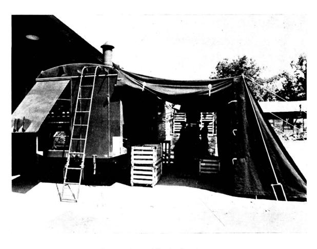
Panetteria mobile in funzione. A sinistra, la tavola di comando con il generatore elettrico; sotto la tenda, le casse per il raffreddamento del pane.
