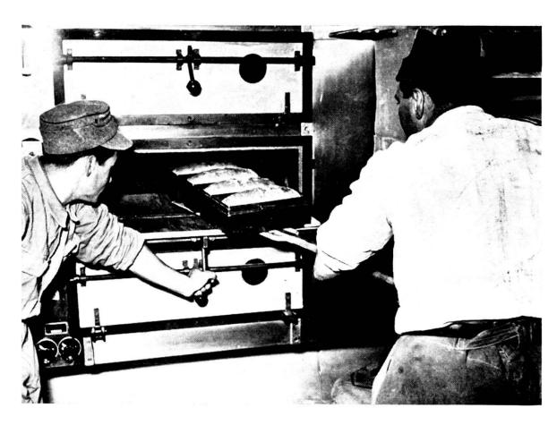
Veduta parziale dei tre forni di una panetteria mobile. La forma rettangolare del pane ne facilita l'immagazzinamento ed il trasporto.
