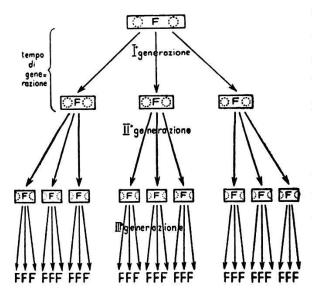
a lato. In esso il rettangolino con una «F» indica la fissione del nucleo, le due sferette tratteggiate nei rettangoli indicano i frammenti di fissione, le frecce che si dipartono indicano i neutroni da fissione, la lunghezza delle frecce rappresenta il cammino percorso, infine il mero delle frecce mostra il moltiplicarsi dei neutroni ad ogni fissione. Tutto è chiaro in questo schema, chè esso riassume
