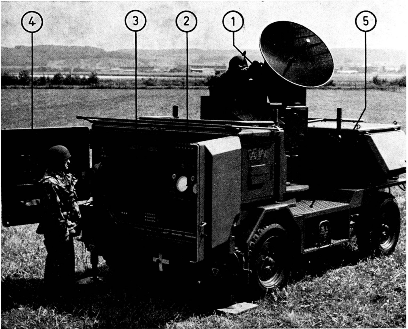
fig. 2 – Centrale di tiro «SUPER-FLEDERMAUS» 1. Colonnina di punteria – 2. Radar di ricerca e di tiro – 3. Calcolatore elettronico – 4. Apparecchio di misura V_0 – 5. Carro di trasporto a due assi.
