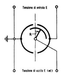
fig. 5 - Principio del calcolo mediante il condensatore
