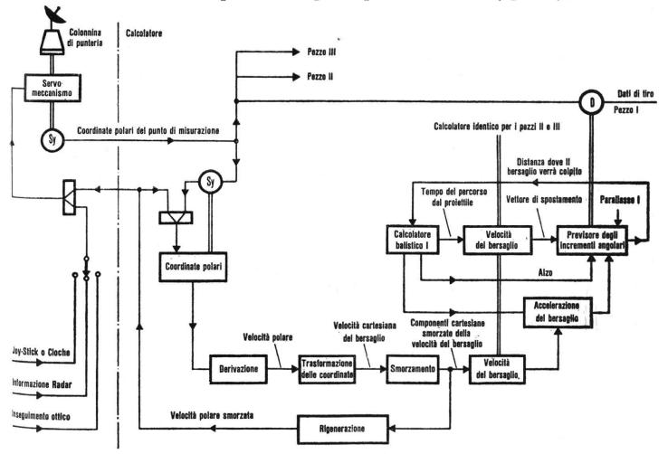
fig. 6 - Schema di funzionamento del calcolatore elettronico
