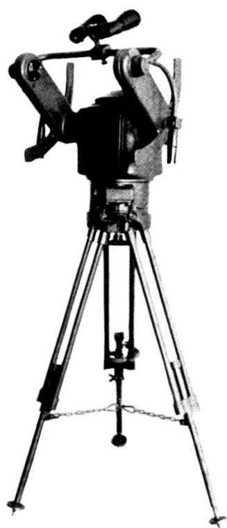
fig. 3 — Puntatore ottico ausiliario
