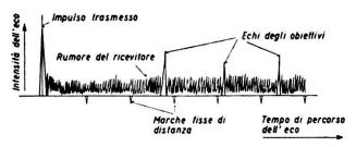
fig. 4 - Indicatore «A» con marche fisse di distanza.
