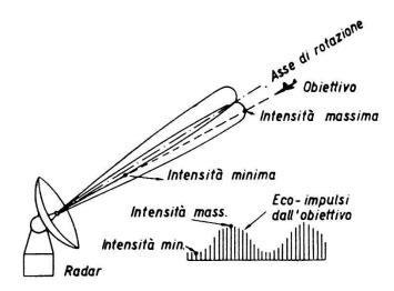
fig. 6 - Ricerca conica e modulazione dell'intensità degli echi.
