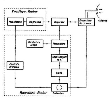
fig. 2 - Schema a blocchi d'un radar ad impulsi.
