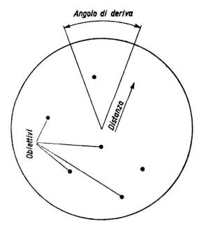
fig. 5 - Sistema di indicazione PPI
