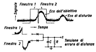
fig. 7 - Generazione della tensione d'errore di distanza.
