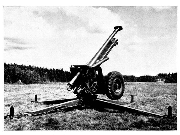
Obice BOFORS 10,5 in assetto di tiro campo di tiro in elevazione —5  $^{\circ}$  / — 65  $^{\circ}$  campo di tiro in direzione 360  $^{\circ}$
