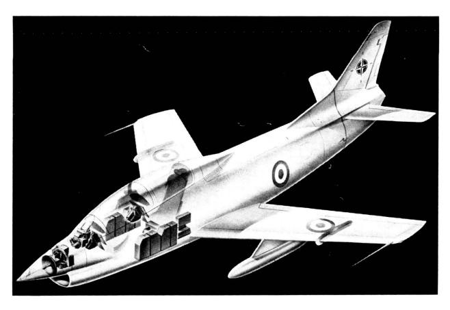
Le apparecchiature elettroniche del «G. 91. T/4» per l'addestramento dei piloti destinati ai caccia della classe Mach 2
