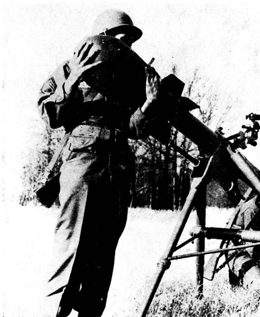
4. USA: Lancia-granate senza rinculo «Davy Crockett»; peso dell'arma 95 kg., peso del proiettile nucleare ca. 35 kg.
