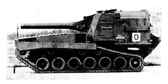
Semovente M 55 in dotazione presso le Divisioni Statunitensi: obice cal. 203 mm. a munizione nucleare di 2 — 5 KT; gittata sui 17 km.; peso 47 t.
