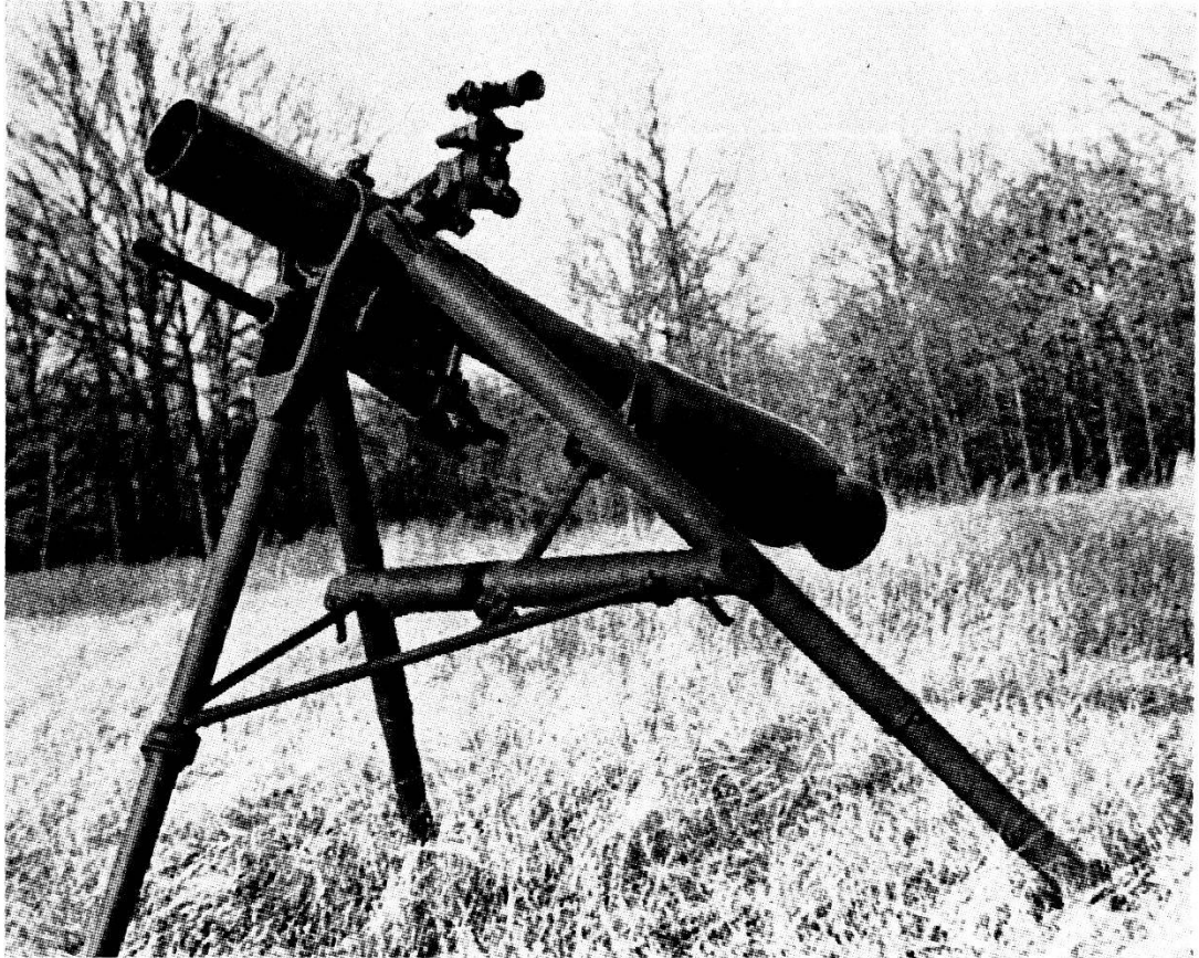
STATI UNITI D'AMERICA: esecuzione leggera del «Davy Crockett», a due serventi; peso sui 100 kg.
