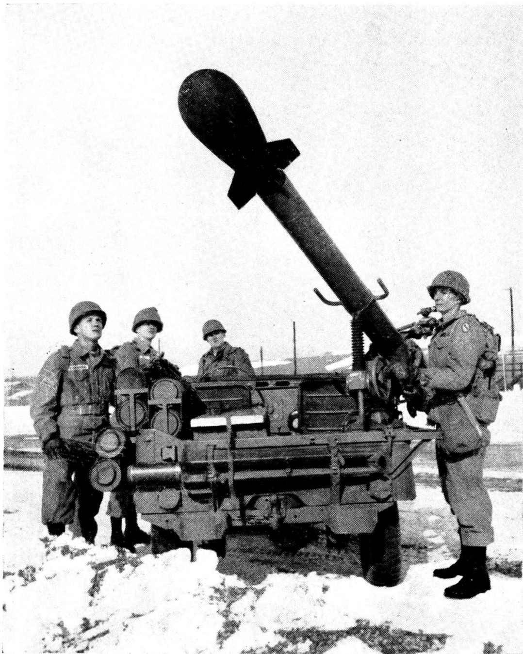
STATI UNITI D'AMERICA: lanciagranate pesante senza rinculo «Davy Crockett» a munizione nucleare di piccolo calibro (0,1 — 1 KT) e gittata sugli 8 km.; montato su mezzo leggero di fanteria; peso del lanciagranate 180 kg.
