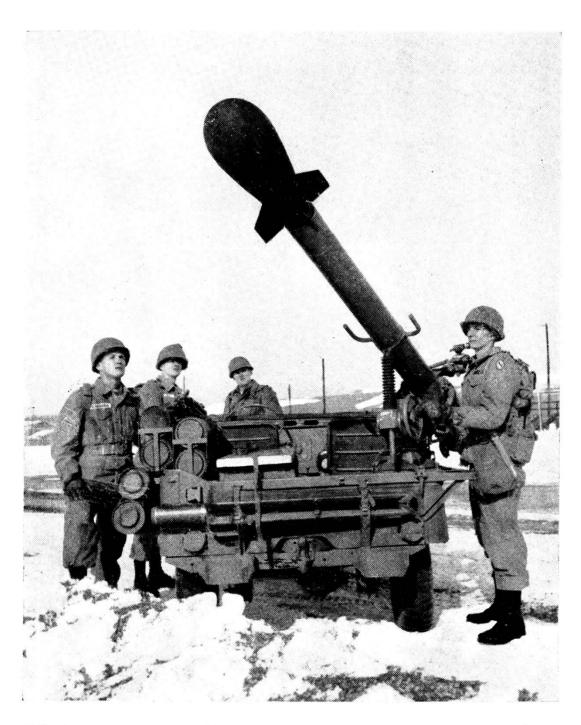
STATI UNITI D'AMERICA: lanciagranate pesante senza rinculo «Davy Grockett» a munizione nucleare di piccolo calibro (0,1 — 1 KT) e gittata sugli 8 km.; montato su mezzo leggero di fanteria; peso del lanciagranate 180 kg.
