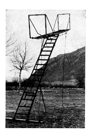
Telaio per la determinazione della velocità iniziale  $\mathbf{V}_0$
