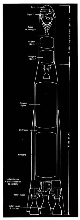
Schema di un ATLAS modificato per la messa in orbita di una capsula abitata. E' reso evidente qui il principio della *pluralità degli stadi* e quello del rapporto di massa.
