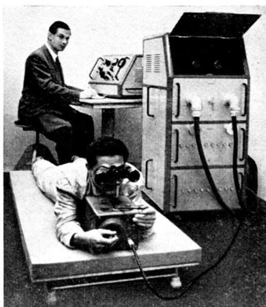
Attrezzatura di addestramento Moschito: apparecchio di guida e simulatore di volo.
