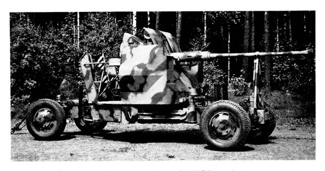
Cannone antiaereo automatico «BOFORS», cal. 40 mm in assetto di traino
