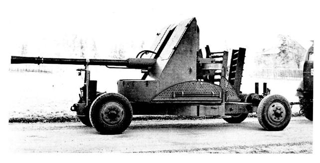
Cannone antiaereo automatico « BOFORS », cal. 57 mm in assetto di traino
