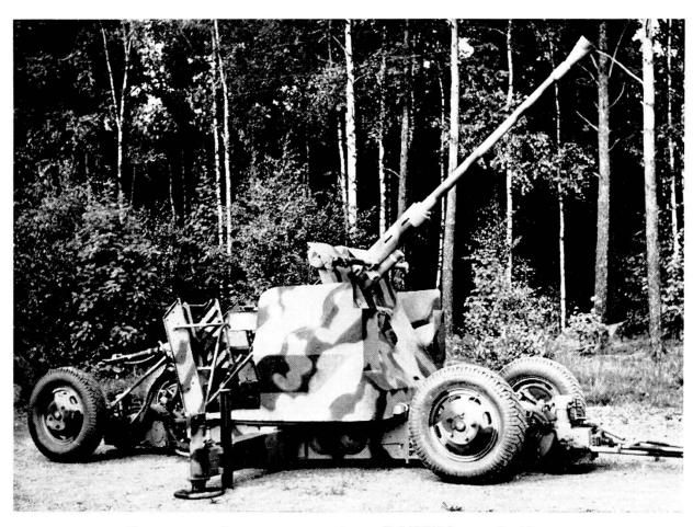
Cannone antiaereo automatico « BOFORS », cal. 40 mm in assetto di tiro
