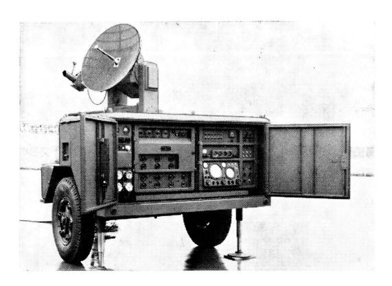
Calcolatore elettronico per la condotta di tiro Flg. 56 « Fledermaus » « Pipistrello » della CONTRAVES, Zurigo, munito di radar intieramente automatico della ALBISWERK, Zurigo.
