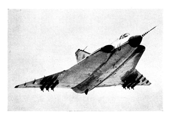
Il SAAB-35 Draken può essere dotato di armamento vario che in parte viene appeso alla superficie inferiore delle ali.
