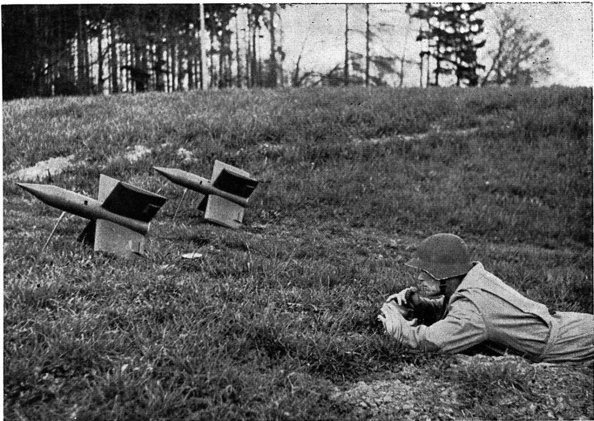
Nido anticarro Tiratore, apparecchio teleguida con cavi di collegamento, 2 razzi
