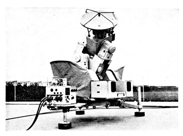
Puntatore radar di batteria
