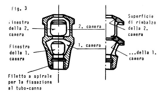
I gas bruciati battono contro le superfici che si trovano sul medesimo asse dell'anima del tubo (superfici di rimbalzo) e vengono deviati attraverso le aperture laterali commutandosi in energia di eflusso. Ne consegue una spinta verso l'avanti che causa la reazione opposta al movimento di rinculo, ossia:  $\underline{m}_1 \cdot V_0 + \underline{m}'' \cdot V = \underline{m}' \cdot V + \underline{M}_V$
