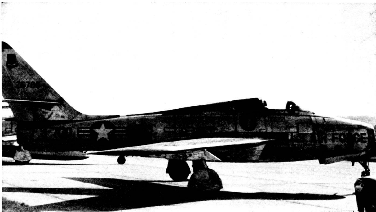
Il « THUNDERSTREAK » F-84 F. Il timone di profondità si presenta applicato al timone di direzione, e le ali sono più mediane che basse. (USA)
