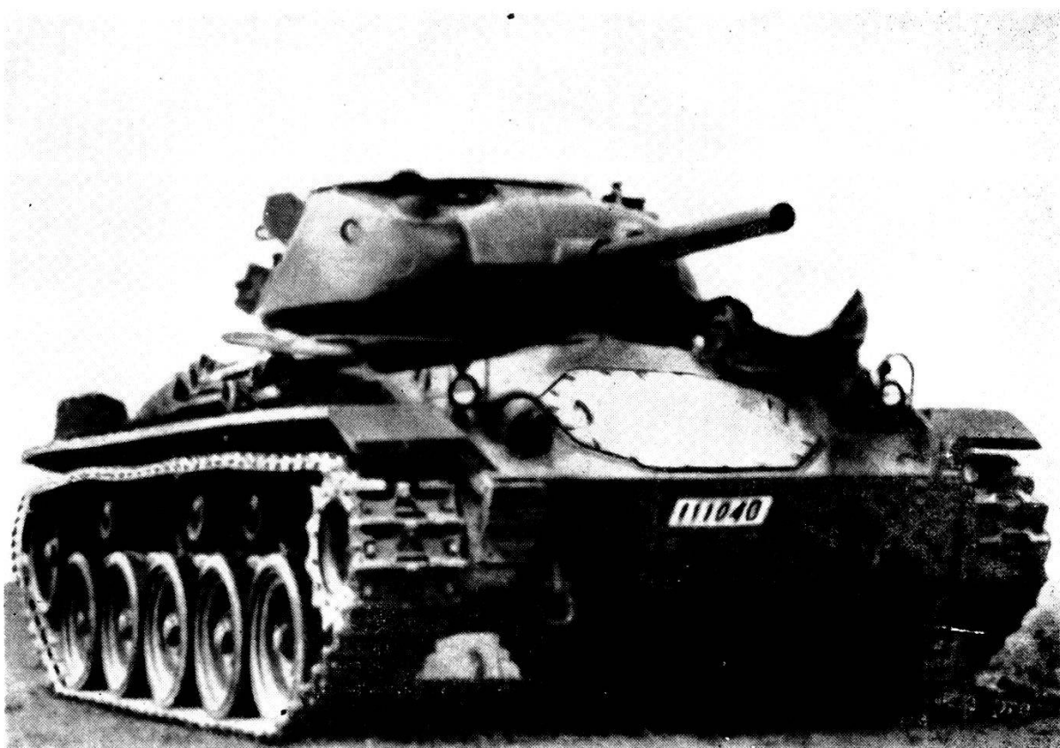
Il carro medio M - 24 GENERAL CHAFFEE (USA) per l'esplorazione presso le forze della NATO; dati: 18 T, 1 cannone da 7,5 cm., 1 mitr.pes., torre mobile, 3-4 uomini, raggio d'azione ca. 200 Km.
