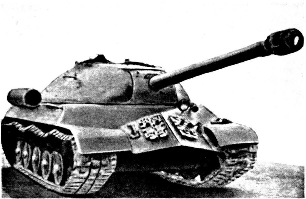
Carro Russo, 51 T. cann. 9 cm., simile, ma più pesante dell'anziano T. 34; carro usato nell'esplorazione forzata.
