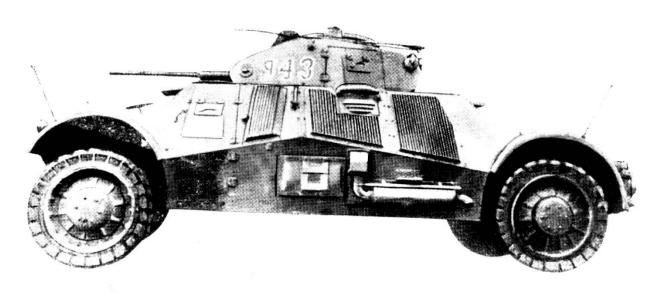
Il PB 22, carro svedese d'esplorazione; 8 T., un cannone leggero, 3 mitr., equipaggio 6 uomini, adatto anche per terreno vario e per il nostro altipiano, molto veloce
