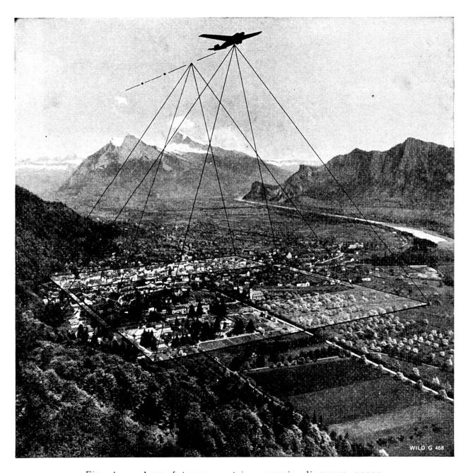
Fig. 4 — Aereofotogrammetria: coppia di prese aeree
