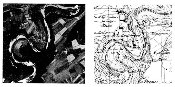
Fig 7 e 8 — Aereofotogrammetria: Confronto fra fotografia e carta topografica (Scala 1 : 25 000)
