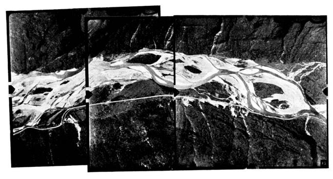
Fig. 5 — Aereofotogrammetria : ricoprimento di una serie di prese. La Maggia fra Visletto e Someo.
