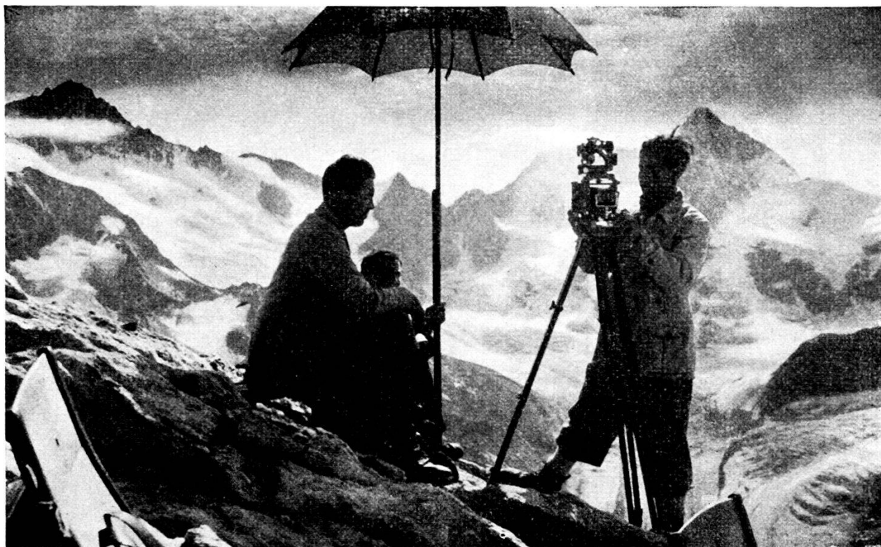
Fig. 1 — Fotogrammetria terrestre : rilievo con il fototeodolite
