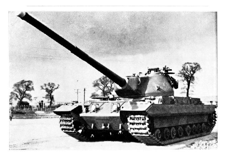
INGHILTERRA. - Il nuovo carro armato « Conquerer » supera i precedenti per potenza di fuoco e velocità. I dettagli tecnici sono ancora sconosciuti; si ritiene che il cannone sia di 120 mm.; a sin. l'apparecchiatura per mitr. e sui lati un'apertura per il lancio delle granate a mano. Viene servito da quattro uomini. La fotografia qui riprodotta è presa sulla pista della fabbrica d'armi presso Leeds.
