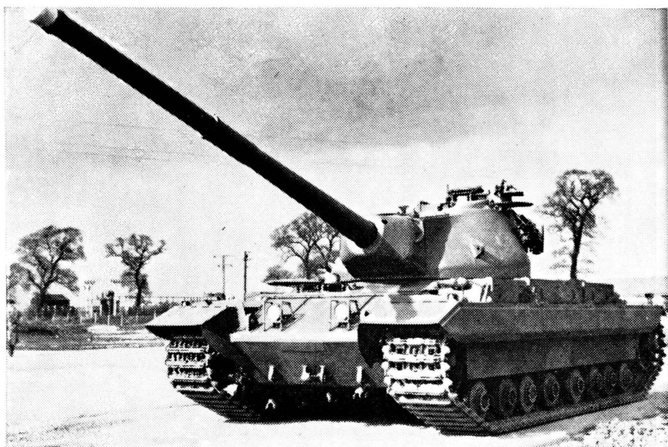
INGHILTERRA. - Il nuovo carro armato «Conqueror» supera i precedenti per potenza di fuoco e velocità. I dettagli tecnici sono ancora sconosciuti; si ritiene che il cannone sia di 120 mm.; a sin. l'apparecchiatura per mitr. e sui lati un'apertura per il lancio delle granate a mano. Viene servito da quattro uomini. La fotografia qui riprodotta è presa sulla pista della fabbrica d'armi presso Leeds.
