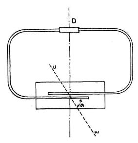
Innescando ai due estremi opposti due identici elementi di miccia detonante, i cui secondi estremi poggiano su una lastra di piombo di opportuno spessore, si otterranno all'atto dell'esplosione due impronte parallele incise sulla lastra, lasciate dalle micce, ed una trasversale che forma con esse l'angelo a, che rappresenta la traccia della collisione avvenuta tra i due fronti d'onda.
