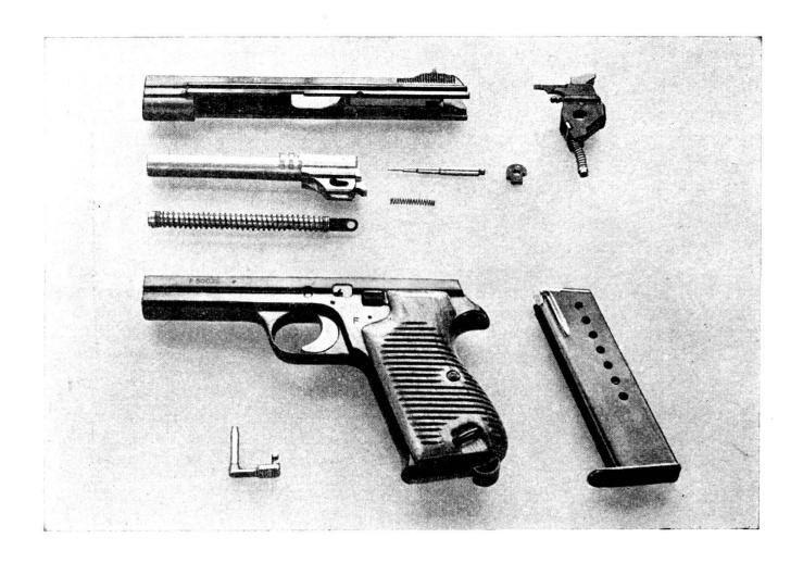
Pistola scomposta, con cilindro-otturatore, canna colla camera inclinata per l'introduzione delle cartucce, l'intaglio di guida per lo sblocco, e le alette di innesto; spina accensoria; piastrina della spina accensoria; molla di ricupero completa; impugnatura colla leva di sicurezza; magazzino; arresto del cilindro-otturatore.
