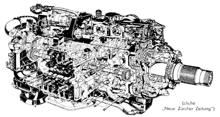
Motore NAPIER "Sabre" di 2400/3000 CV a 3850 giri/min.
