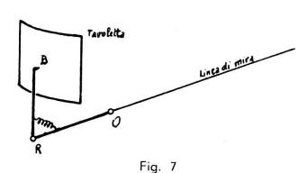
La tavoletta è cilindrica, la cerniera in O è sferica, quella in R è solo nel piano verticale. L'asta BR è premuta contro la tavoletta da una molla. La figura è simmetrica nelle direzioni, asimmetrica nelle elevazioni ed è capovolta. I punti in alto del terreno risultano in basso della tavoletta e viceversa.
