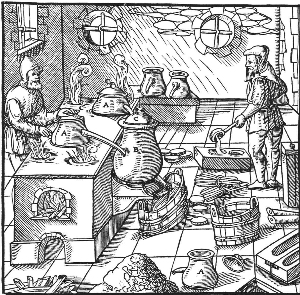
Fig. 1. — La purification du soufre décrite par G. Agricola, au XVI e siècle
