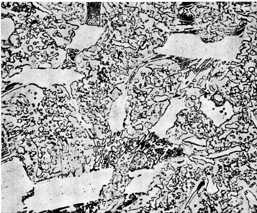
Fig. 38. — Perlite granuleuse, eutectique des phosphures. (Grossissement 250 fois.)
