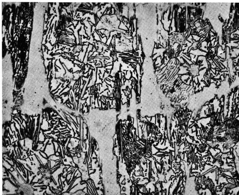
Fig. 45. — Perlite lamellaire grossière. (Grossissement 500 fois.)
