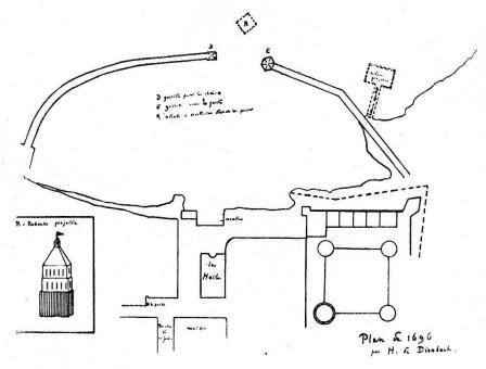
Le port achevé, d'après le plan de H. de Diesbach (1696). La redoute R, barrant l'entrée du goulet, ne fut heureusement pas construite, ni celle qu'on voit à droite de la digue côté vent. D guérite pour les chaînes, E guérite pour le garde.
