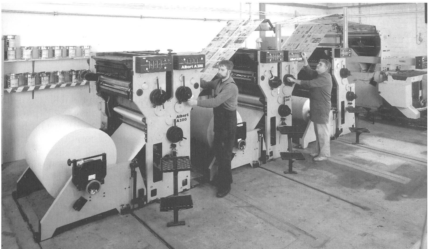
Die heutige Offsetrotation für den 24seitigen Zeitungsdruck, mit Falzapparat.
