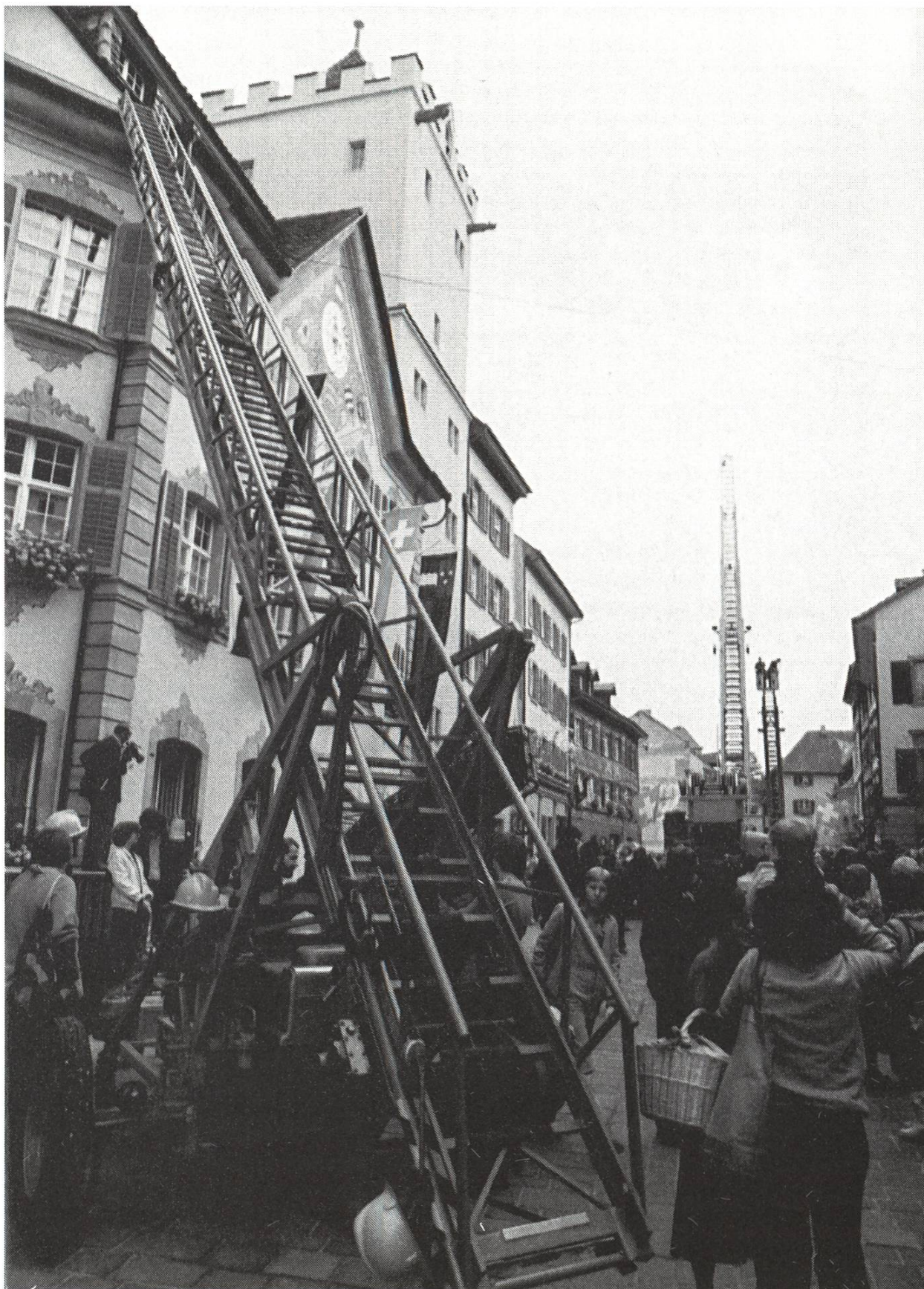
In den 70er Jahren ersetzte die Ehram-Anhängerleiter ALN 22 m mit mechanischem Handantrieb die Strebenleiter und die mechanische Drebleiter aus dem Jahre 1929.
