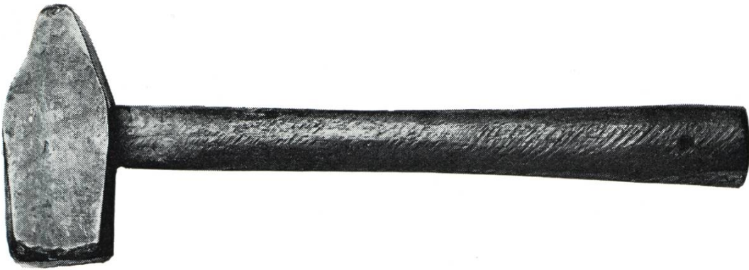
Spannhammer. Länge: 38 cm
