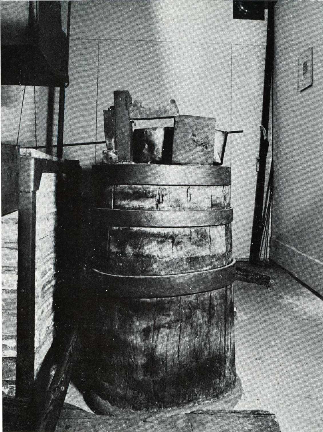
Nagelstock. Unterhalb des untersten Reifs Löcher für den Austritt des Hammerschlages. In der Ecke Eisenstäbe, aus denen die Nägel geschmiedet werden
