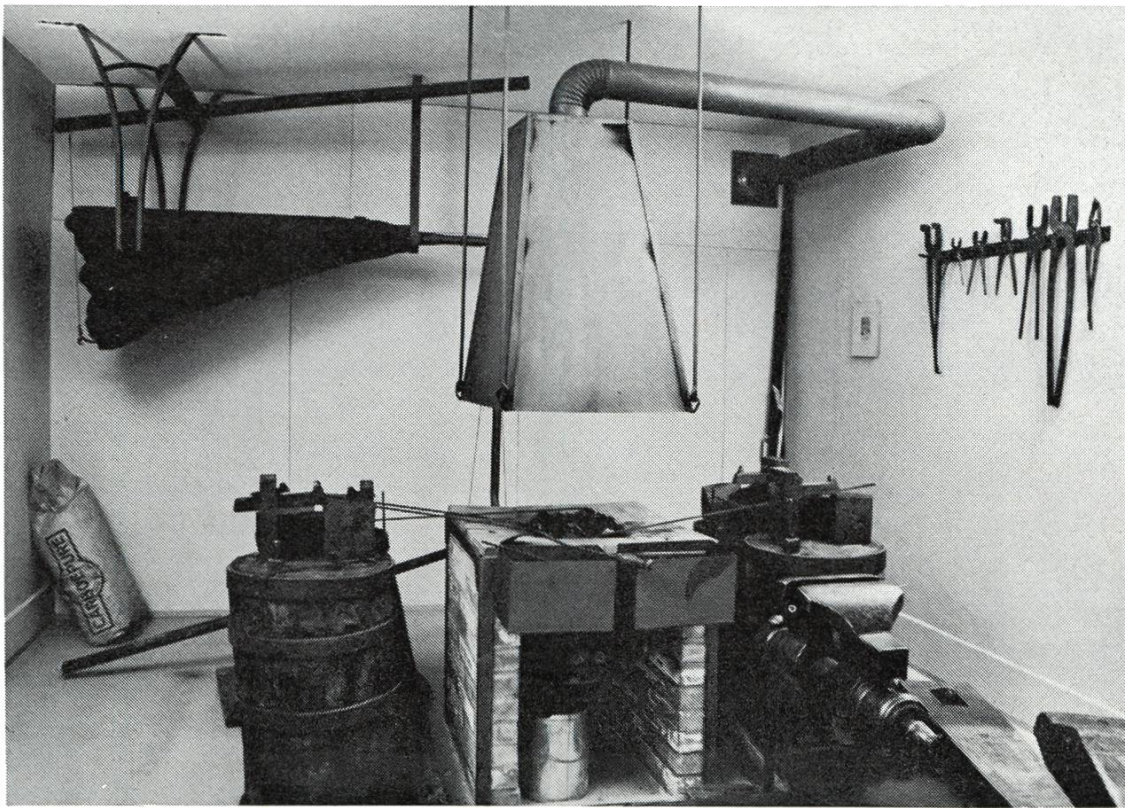
Der Schmiederaum. In der Mitte die Esse, links und rechts davon die Stöcke, an der Decke der Blasebalg
