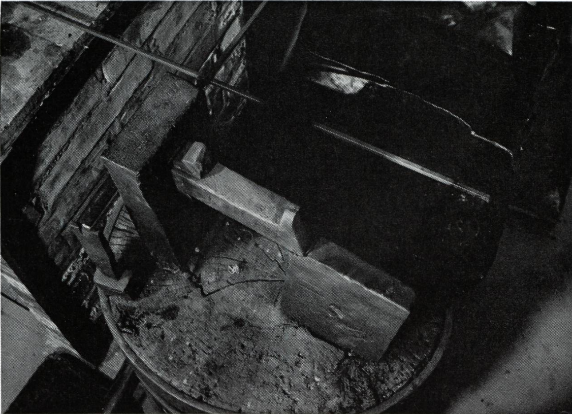
Das Geschirr. Schrote aus einem alten Feilenblatt
