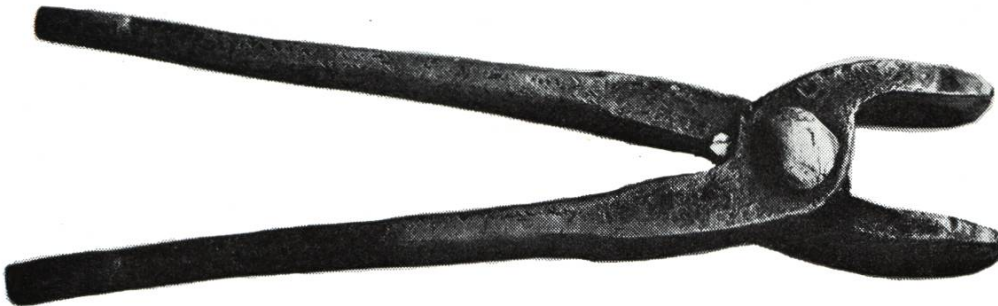
Zange zum Halten des Nageleisens beim Abrichten. Länge: 26 cm
