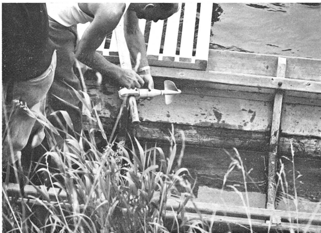
Bild 4. Der hydrometrische Flügel (Instrument zur Messung der Strömungsgeschwindigkeit des Wassers) wird an der Stange befestigt.
