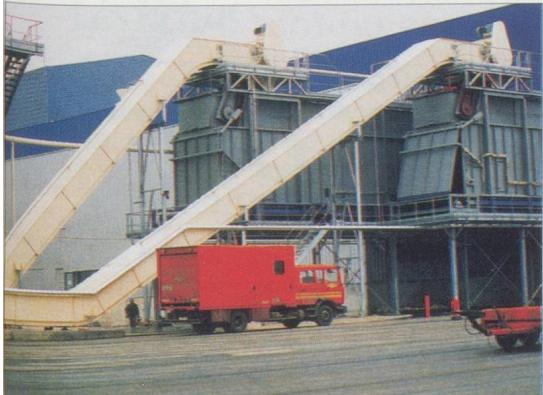
copeaux de bois destinés à la fabrication d'un nouveau type de panneaux agglomérés. Ce système de transport, bien particulier, nécessite un développement spécifique et novateur que Buhler a su anticiper. Une longueur d'avance sur ses concurrents qui lui permet d'adapter ces installations à toutes autres sortes de produits.
