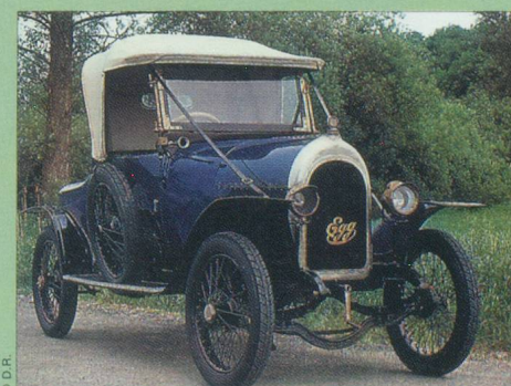
Torpédo deux places Egg de 1919, animée par un moteur 4 cylindres Zurcher à soupapes latérales, carburateur Zénith et exhausteur Orion.
