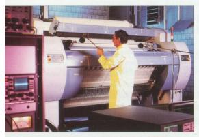
Mesure du bruit sur une machine à tisser M8300. Le niveau sonore de cette machine est deux fois plus bas que celui des systèmes de tissage en usage
