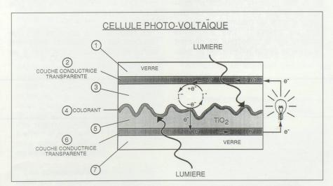
Figure 4 : Construction d'un module sur des électrodes de verre transparent : (1) et (7) plaques de verre ; (2) et (6) couches conductrices transparentes ; (3) électrolyte contenant le couple rédox ; (4) couche monomoléculaire de colorant absorbé à la surface de la membrane de TiO<sub>2</sub>; (5) membrane rugueuse de TiO<sub>2</sub>.
