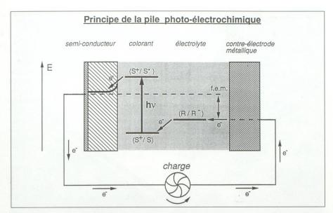
Figure 3 : Représentation schématique d'une cellule photoélectrochimique régénérative afin d'illustrer l'origine du photopotentiel.
