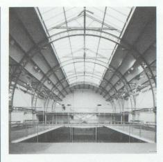
Pavillon de l'Arsenal à Paris : Dans une halle du XIXe siècle, un étage d'exposition a été créé. Le nouveau plancher est suspendu à un réseau de câbles, selon une technique contemporaine intégrée dans la structure ancienne.
