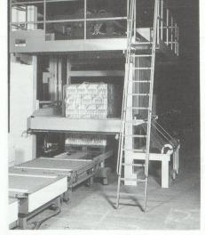
Suremballage des charges palettisées sous film rétractable. Photo : Suremballeuse intégrale Uni-Pal<sup>®</sup> Thimon, Aix-les-Bains.
