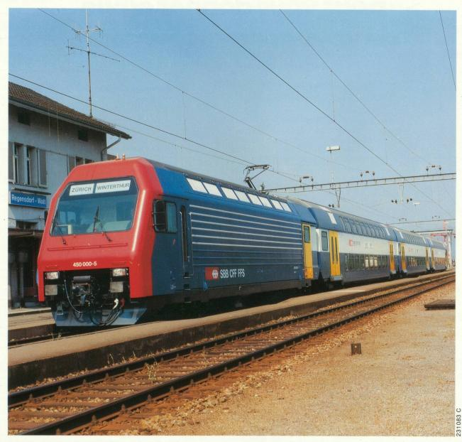
Composition réversible CFF du RER zurichois comprenant une locomotive Re 4/4 450 et trois voitures à deux niveaux. Longueur 100 m, capacité: 399 places assises, puissance continue: 3000 kW, vitesse maximale: 130 km/h.
