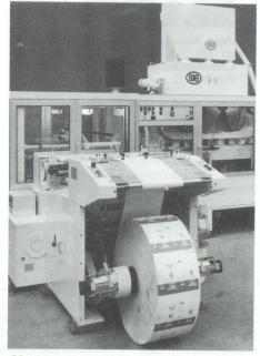
Machine type PRD pour le conditionnement de sucre cristallisé en sacs papier confectionnés à partir d'une bobine. Débit : jusqu'à 130 sacs/mn.
